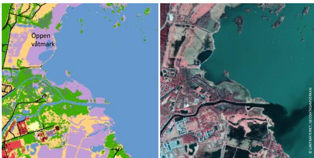
Figur 12. NMD2023 v01 och IR ortofoto (2020) vid Örebro. Gränsdragning mellan öppen våtmark och friskare/fuktigare gräsmark är en utmaning. Vatten är enligt Lantmäteriets kartdata. Koordinat: 515 005, 6 571 804.
