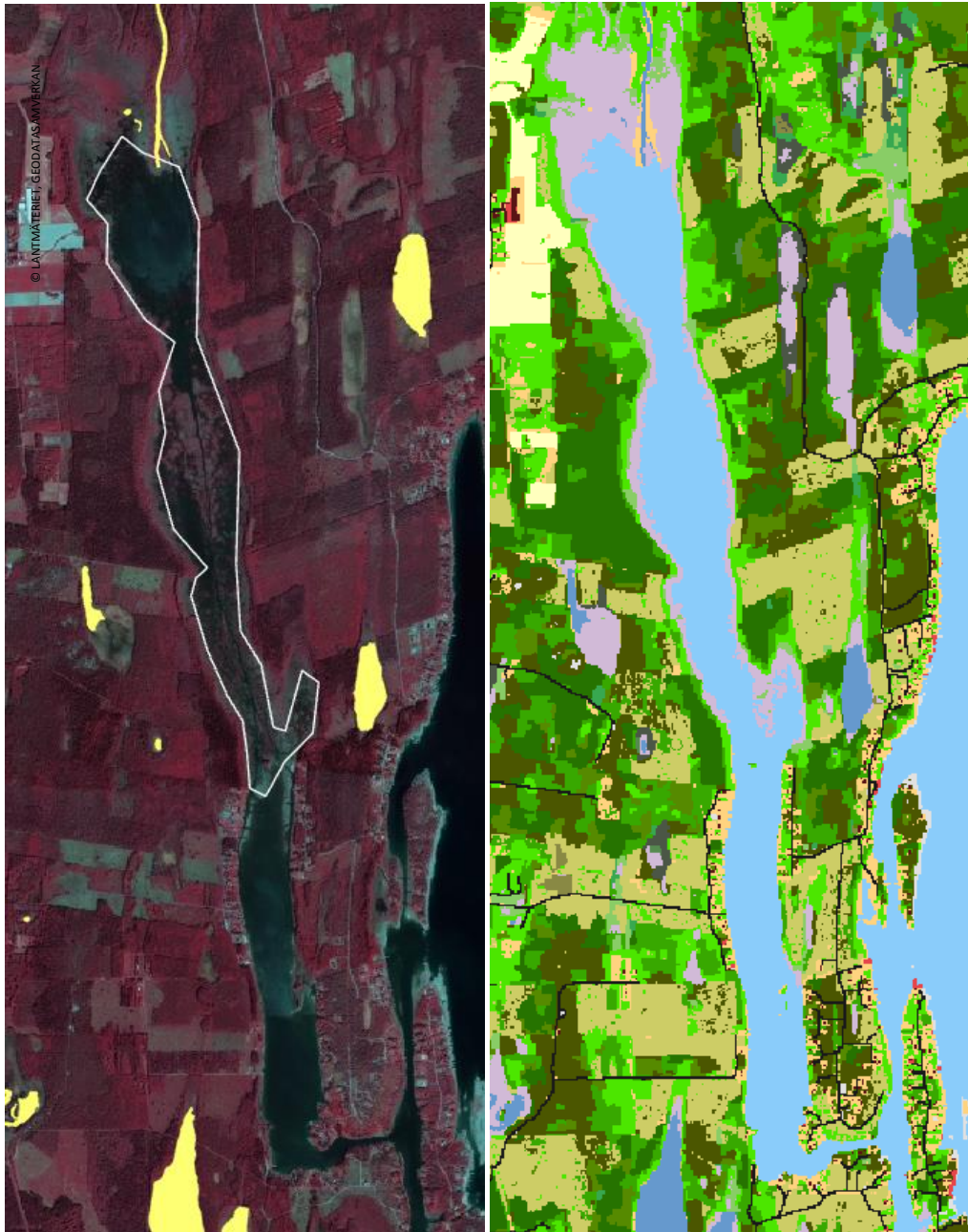
Figur 33. I ortofotot till vänster (IR 2018) finns ett område i Tavlefjärden markerat med vit linje. Här kan det ifrågasättas huruvida det bör klassas som Hav eller Sjö och vattendrag. Eftersom hela området saknas i Hydrografiprodukten (markerat i gult i vänster bild) har det emellertid klassats som Hav (62). Exemplet är hämtat från Västerbotten.
