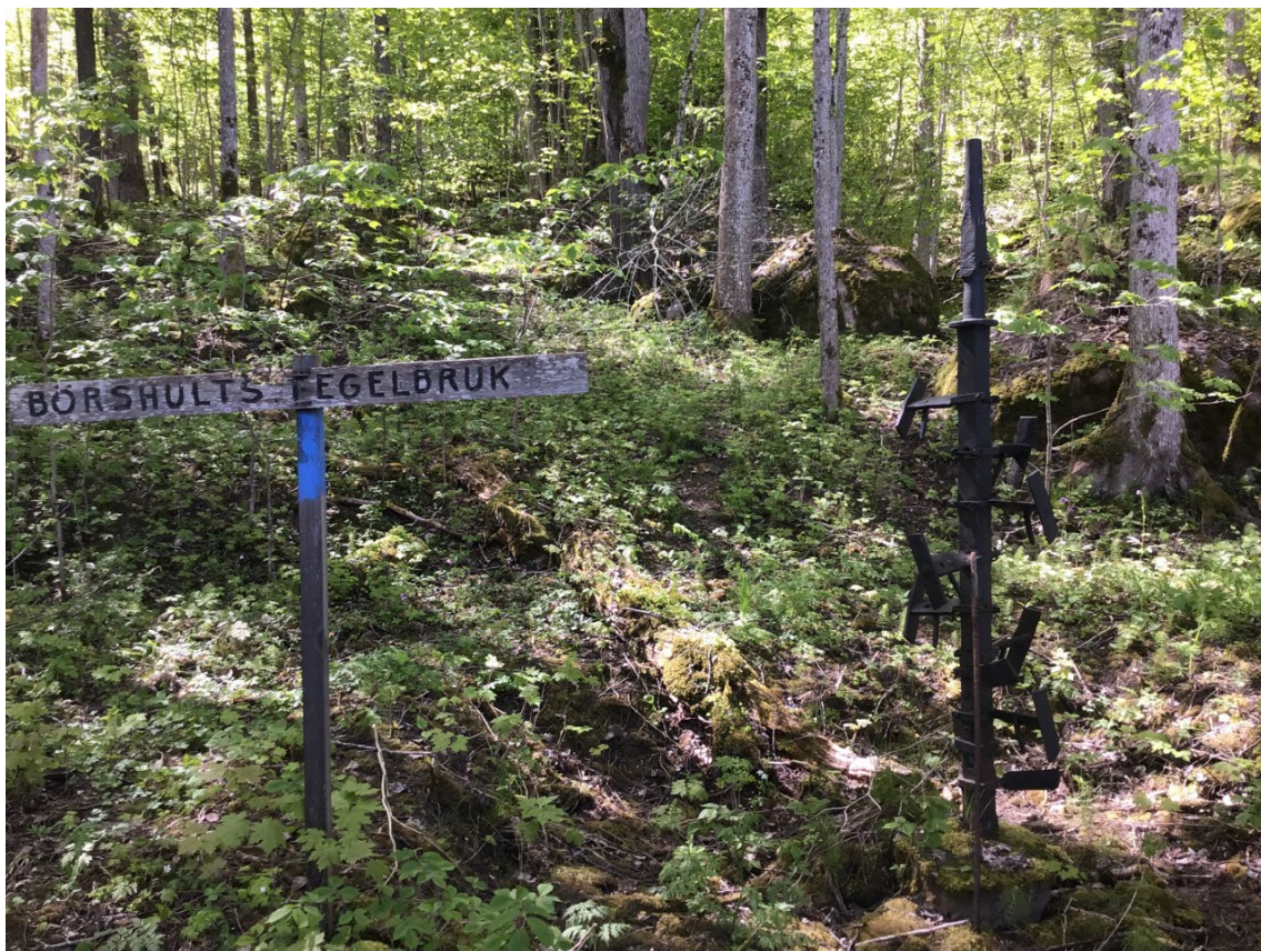
Lämningar efter Börshults tegelbruk finns i naturreservatet. Leran som teglet tillverkades av bearbetades i en "oxvandring", där lerkransen drogs av en häst som gick runt en kraftig järnpåle som syns till höger i bilden.
