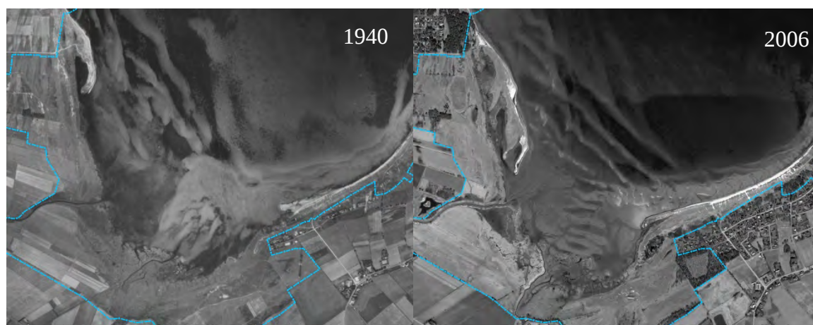
Figur 4 a och b. Jämförelse av flygbild från 1940, till vänster, och 2006, till höger. Revelln Surkenabben i nordväst har byggts på med material, söderut, och laguner bildats in mot land. Västra delen av Farhultsbadens strand har å sin sida pålagrats med sand västerut. Viken Halså minskar sålunda i utbredning. © Lantmäteriet Geodatasamverkan
