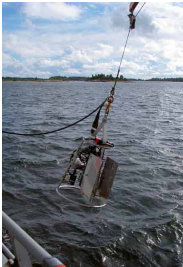
Bottenundersökning utförs med videokamera
