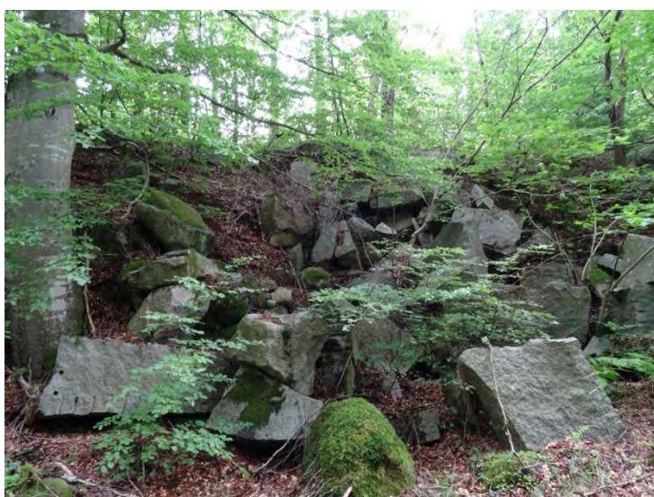
Figur 26. Rester av huggna block och skrotsten ligger kvar vid det stora stenbrottet där det brutits byggnadssten av Halengranit.
