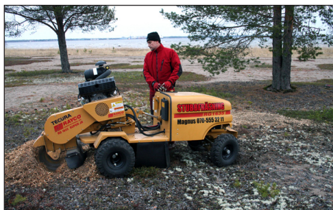
Stubbfräsning är en metod för att ta bort äldre stubbar men även ett alternativ till rottryckning.
